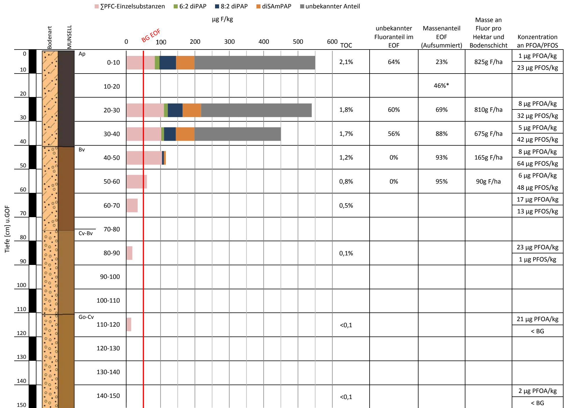
Abbildung 3: Zusammenfassende Darstellung der Analysenergebnisse im Feststoff und des Bodengutachtens am Standort Hügelsheim; *Mittelwert
